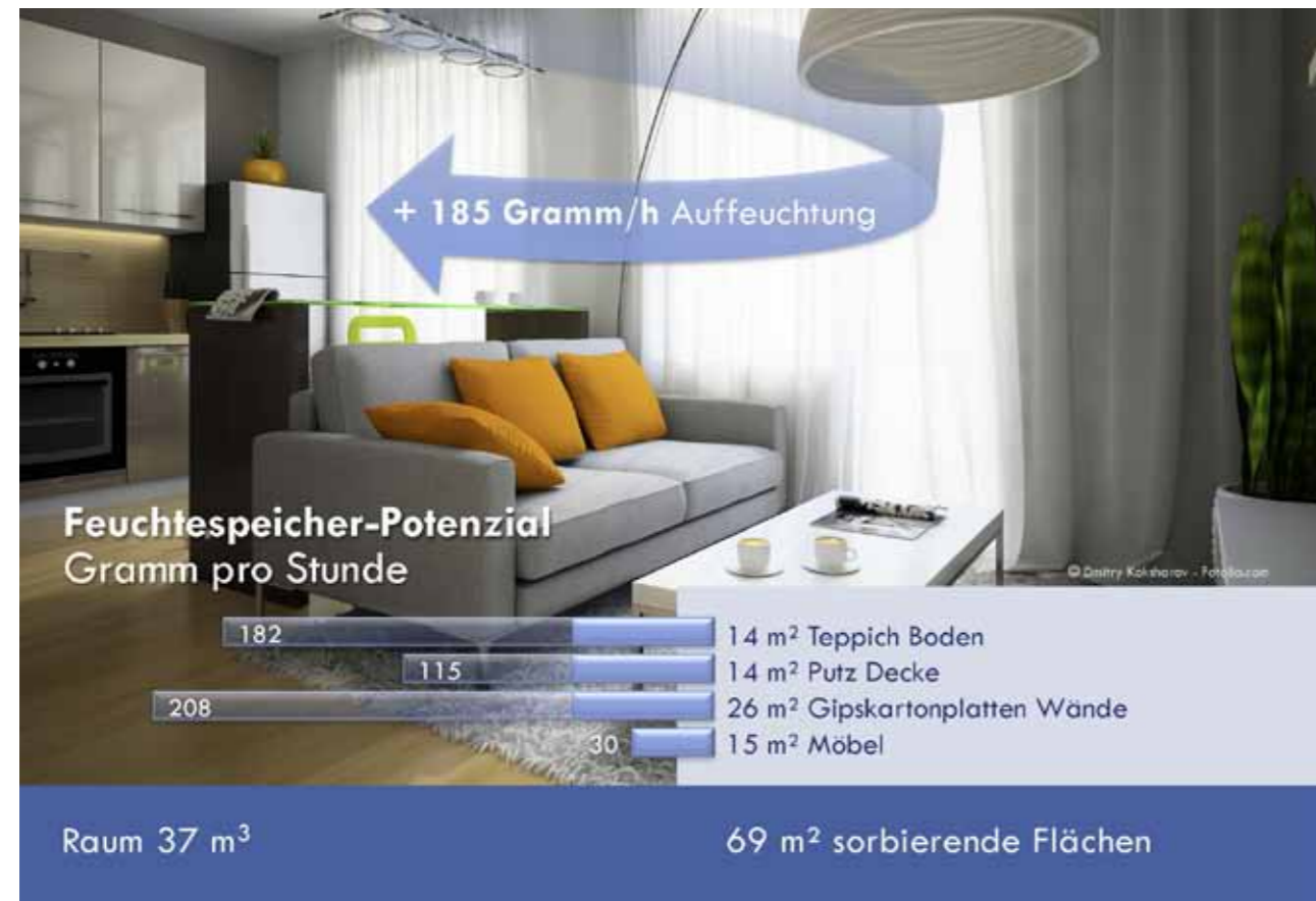
Abb 5 Das Feuchtespeicher-Potenzial der verschiedenen Oberflächen in einem Raum vermag Feuchtespitzen aufzufangen.
